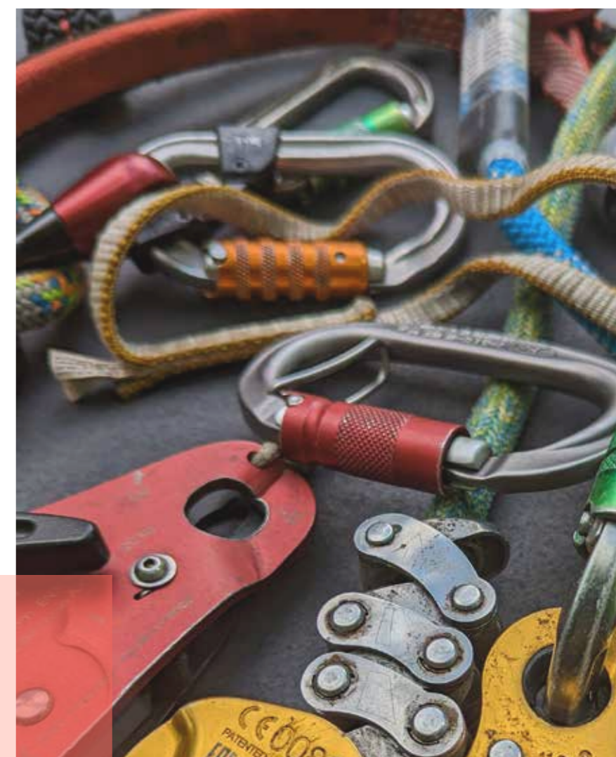
Exempel på CE-märkt personlig skyddsutrustning som används för trädklättring.
