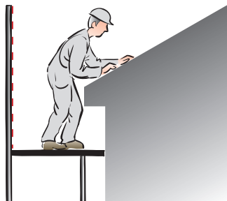
Byggnadsställning vid tak- och takfotsarbete.
